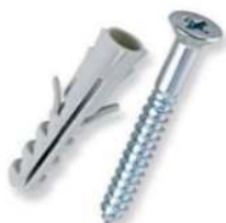
Bucha de nylon sem aba s6, com parafuso de 4,20 x 40 mm em aço zincado com rosca soberba, cabeça chata e fenda Philips
