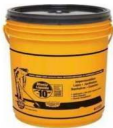
Manta líquida de base asfáltica modificada com a adição de elastômeros diluídos em solvente orgânico, aplicação a frio (membrana impermeabilizante asfáltica)
