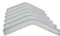
Cumeeira universal para telha ondulada de fibrocimento, e = 6 mm, aba 210 mm, comprimento 1100 mm (sem amianto)
