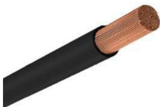
Cabo de cobre, flexível, classe 4 ou 5, isolamento em pvc/a, antichama bwf-b, 1 condutor, 450/750 v, seção nominal 10 mm 2
