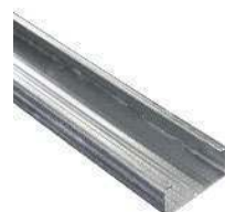
Perfil canaleta, formato c, em aço zincado, para estrutura forro drywall, e = 0,5 mm, *46 x 18* (l x h), comprimento 3 m
