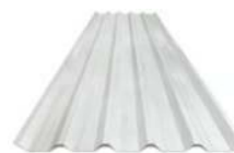
Telha trapezoidal em aço zincado, sem pintura, altura de aproximadamente 40 mm, espessura de 0,50 mm e largura útil de 980 mm.
