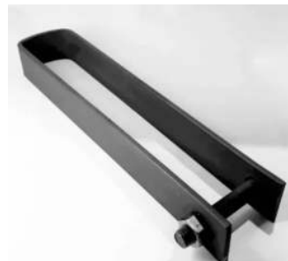
Estribo com parafuso em chapa de ferro fundido de 2" x 3/16" x 35 cm, seção "u", para madeiramento de telhado
