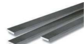
Barra de ferro chato, retangular, 25,4 mm x 4,76 mm (l x e), 1,73 kg/m
