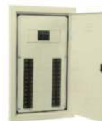
Quadro de distribuição com barramento trifásico, de embutir, em chapa de aço galvanizado, para 12 disjuntores din, 100 a
