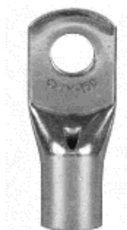
Terminal a compressão em cobre estanhado para cabo 2,5 mm 2 , 1 furo e 1 compressão, para parafuso de fixação m5
